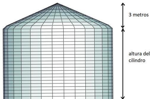
Figure 3: Estructura con base cilíndrica y tapa cónica.
